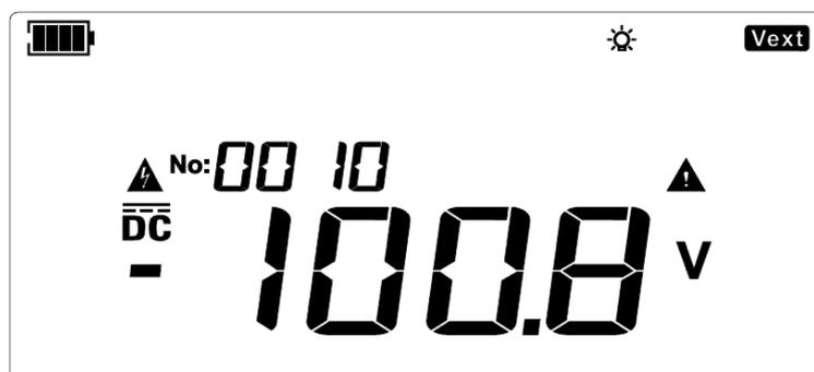
Abbildung 9.24 Negative Messung der DC-Spannung
