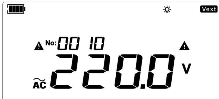
Abbildung 9.23 Messung der AC-Spannung
